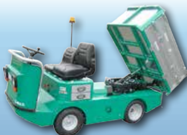
Stama Multitruck Diesel eller el drevet. Hydraulisk tip Fåes i bredden 80 eller 100 cm
