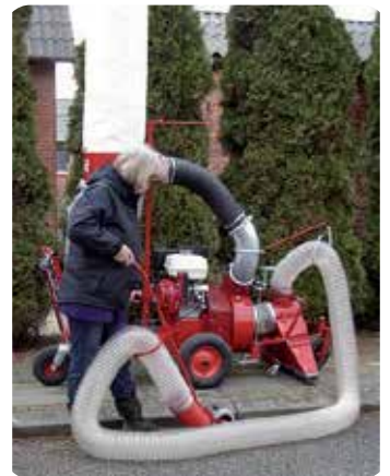
Mobil løvsuger, hydrostatisk fremdrift.
