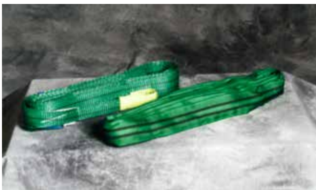
Lovlig løftestrop og rundsling
